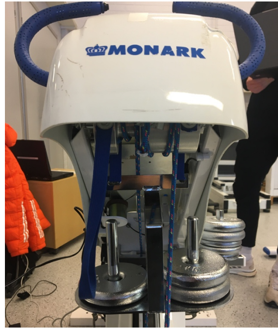
KUVA 1. ja 2. Pyörän virtapainike ja datakaapelin paikka sekä painopakka ja nostonaru.
