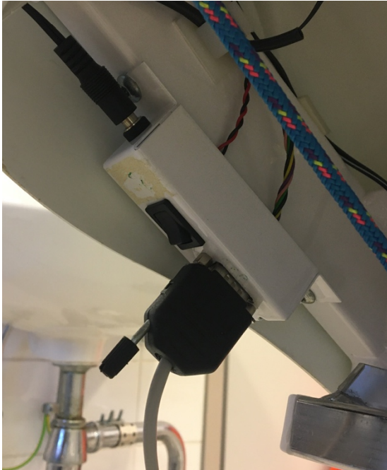
KUVA 1. ja 2. Pyörän virtapainike ja datakaapelin paikka sekä painopakka ja nostonaru.
